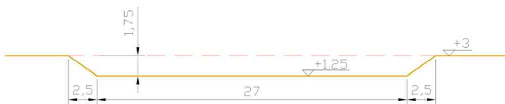
Figura 9. Croquis sección hidráulica Río Chillar. Cotas en metros sobre el NMMA.
