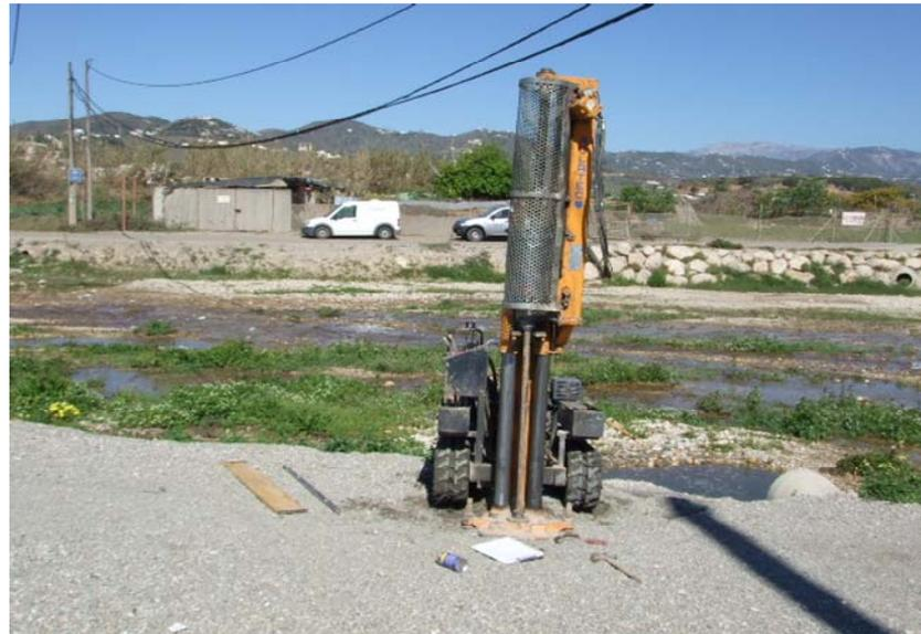
Figura Nº 1.- Trabajos para la ejecución de la penetración dinámica, referida como P-01.
