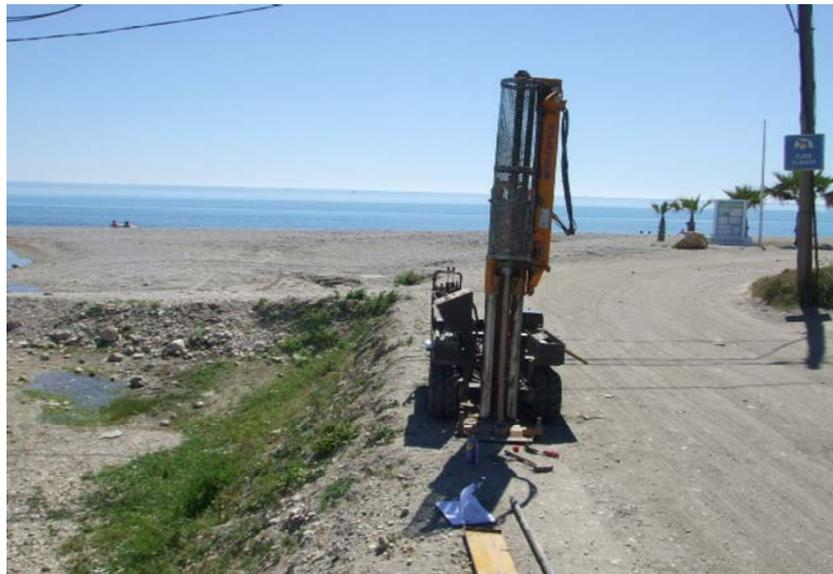
Figura Nº 3.- Trabajos para la ejecución de la penetración dinámica, referida como P-03.
