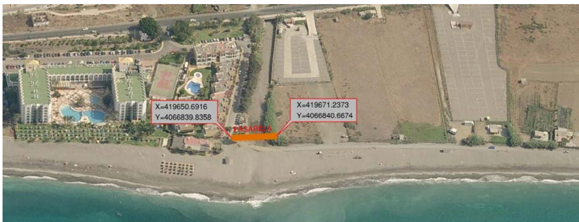
Figura 4. Punto de situación de calicata para pasarela sobre río Seco
